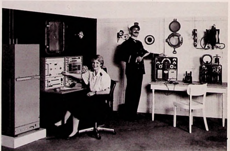
Bild 1: Seefunkstationen heute (links) und damals. Ganz rechts ein Löschfunkensender aus dem Jahre 1911 (DEBEG-Pressbild)
