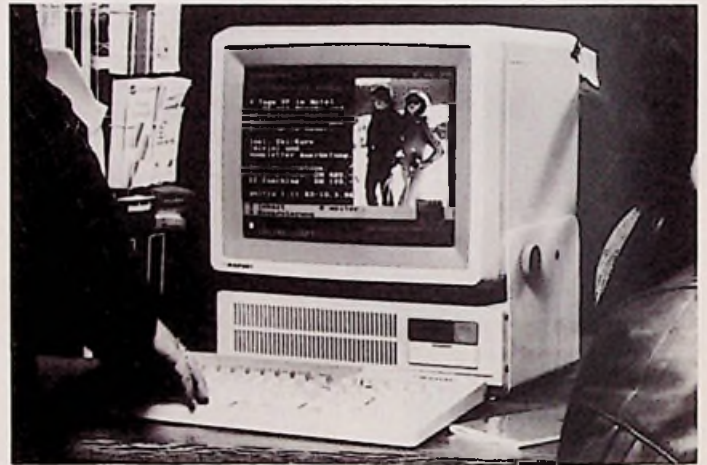
Bild 1: Btx-Signale steuern die Bildplatte im Reisebüro (Blaupunkt-Presebild)
