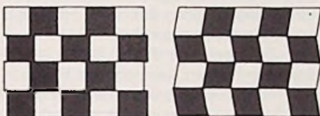
Bild 3b: Mögliche Schirmbilder bei schlechten Klemm- und Synchronabtrennschaltungen
